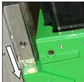
Setzen Sie die Kernbohrmaschine mit der montierten Platte in den Bohrständler ein und Arretieren Sie diese mit Hilfe der Feststellschrauben.
