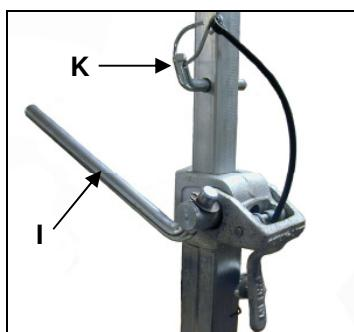
Bevestig de boorinstallatie door de arm (I) rechtsom te draaien. Zet het vast in positie d.m.v. de daarvoor bestemde bout (K).
