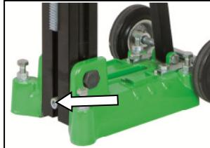
Entfernen Sie die Schraube welche die Bohrsäule bei 90° arretiert.
