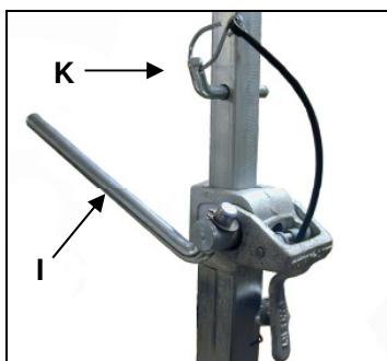
Fixieren Sie den Bohrständler durch Drehen der Kurbel (I) im Uhrzeigersinn. Sichern Sie die Einstellung mit dem dazugehörigen Bolzen (K).
