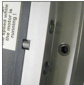
Zum Lieferumfang gehören eine Montageplatte, eine Adapterplatte, 2 Passfedern 10 mm und 8 Innensechskantschrauben. Die Montageplatte wird mit der Passfeder auf die Maschine aufgesetzt und mit den vier kurzen Schrauben befestigt.
