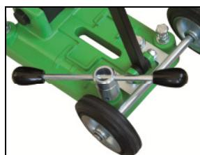
Avant et après de serrer l'écrou (F), réglez les 4 vis arrêteoir pour l'ajustement à la
