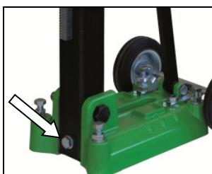
Na het boren van de kolom terug te brengen in de 90 ° -positie.
