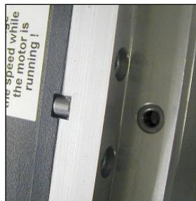
Dit gereedschap wordt geleverd met een montageplaat, een 10 mm plaatsingsssleutel en 4 inbusbouten M8x20. De montageplaat wordt op de boormotor gezet met de plaatsingssleutel en bevestigd met de 4 bouten.
