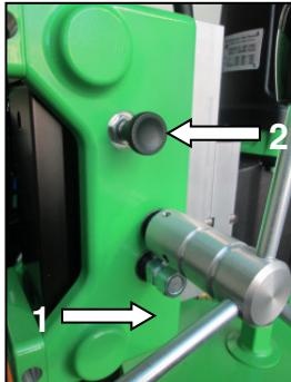
Um den Schlitten (1) zu entriegeln, ziehen Sie den Sicherungsknopf (2) heraus.
