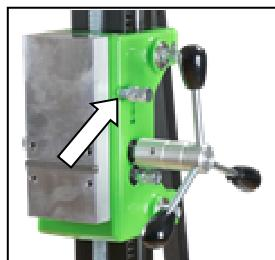
Fahren Sie den Maschinenhalter so weit nach oben, bis dieser in der Endlage einrastet.
