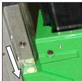
Steek de kernboor met de bevestigde montageplaat in de boorinstallatie en vergrendel deze met de draaihendel (zie bovenstaande afbeelding).
