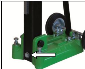
Verwijder de schroef die de pillaar op 90° vergrendelde.
