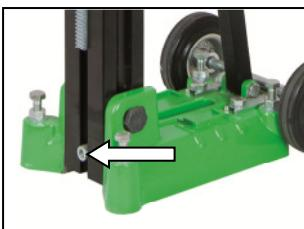
Nach dem Bohren ist die Säule wieder in die 90° Position zu bringen.
