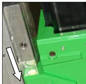
Insérez la carotteuse avec le support de montage joint dans le support de forage et bloquez-le avec la manette (voir photo ci-dessus).
