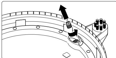
**1.** Schrauben Sie die 2 Düsen aus dem Winkel am Reinigungsrotor.
