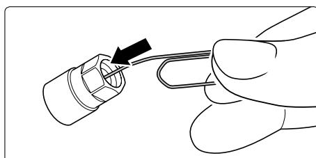
**3.** Reinigen Sie die Düsen mit dem Drahtende der Büroklammer.
