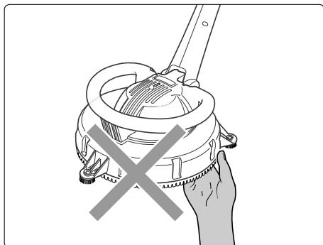
**Ne jamais mettre la main sous l'appareil raccordé au nettoyeur et prêt au service!**
