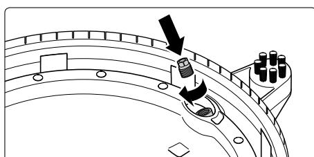
**4.** Spülen Sie den Hochdruckschlauch und den Reinigungsrotor durch. Schrauben Sie die Düsen wieder ein. Verwenden Sie hierzu ein Teflonband zum abdichten. ... und sofort können Sie wie gewohnt weiterarbeiten!
