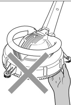
**Nicht unter das angeschlossene und betriebsbereite Gerät greifen!
