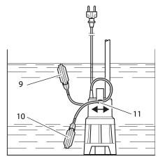
Das Kabel für den Schwimmerschalter kann im Kabelhalter (11) verschoben werden. Hierdurch wird der Abstand zwischen Einschaltpunkt und Ausschaltpunkt verstellt:
