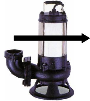
Wenn die Pumpe anläuft, übt sie einen Ruck entgegen dem Uhrzeigersinn aus (von oben gesehen). Bei falscher Drehrichtung sind zwei der Phasen U, V und W durch den qualifizierten Elektriker zu vertauschen.
