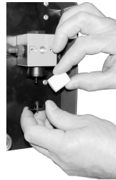
6) Neuer Filtereinsatz auf Kunststoffkappe setzen Set new filter cartridge on the plastic cap
