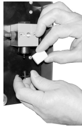
5) Filtereinsatz von Kunststoffkappe entnehmen Take the filter cartridge of the plastic cap
