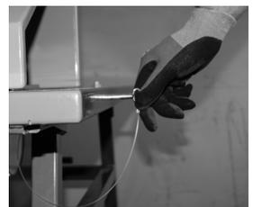
Die Ausnehmung in der Sägeblatteinlage darf beidseitig des Sägeblattes nicht mehr als 3 mm betragen. Darin können sich leicht Holzsplitter verklemmen oder herausgeschleudert werden. Ein zu breiter Sägeschlitz ist deshalb unverzüglich zu verringern. Durch Betätigen des Niederhalters löst sich die Verriegelung des Tisches. Nach dem Loslassen des Niederhalters fährt der Tisch selbstständig in seine Ausgangsposition zurück und die Verriegelung rastet erneut ein.
