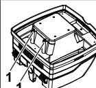
Die Wasserstandssensoren (1) regelmäßig reinigen und auf Anzeichen von Beschädigung untersuchen.
