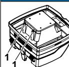
Vatteninnivåsensorerna (1) ska rengöras regelbundet och undersökas efter tecken på skador.
